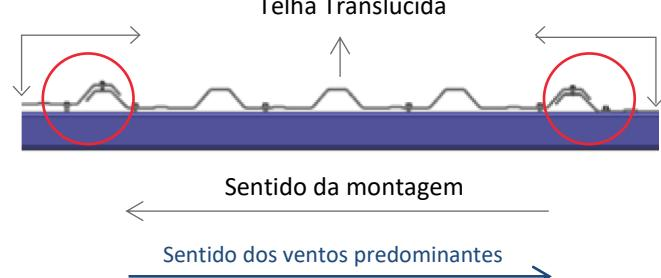
utilizar padrão descrito acima (1. Aplicação de telha translúcida – fixação na onda baixa).
