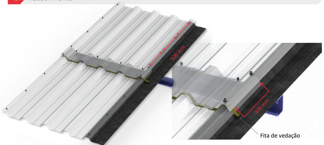
Para recobrimento longitudinal recomenda-se aplicar fita de vedação, fixar parafuso de costura a cada 500 mm.
