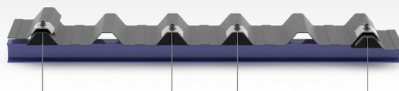
Fixação com calço, goiva e parafuso
