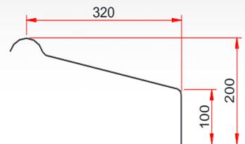
Para aplicação de cumeeira universal utilize fita de vedação nas sobreposições transversal e longitudinal. Para fixação utilize três parafusos na linha da terça.
