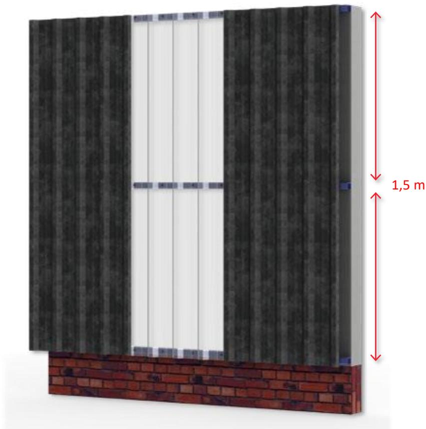
**5.1** Telha translúcida entre telhas metálicas
